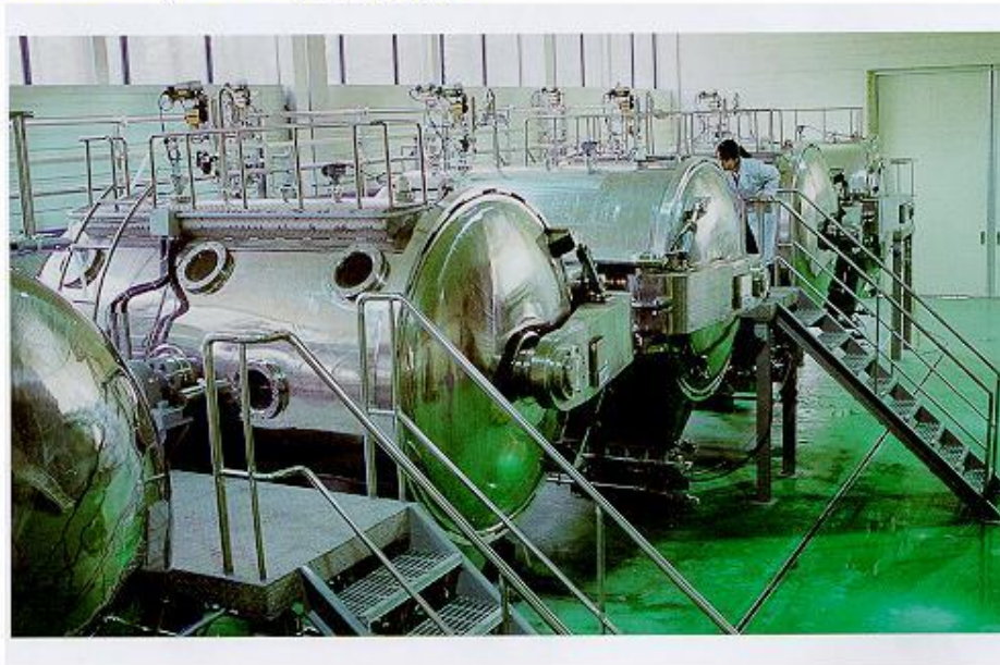
Bioreactor (5 ton each) 生物反應器
